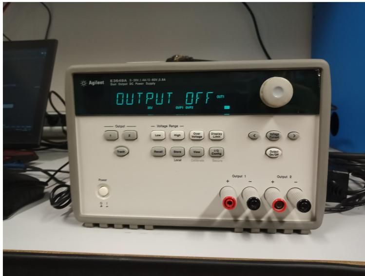
Figure 53: Un Générateur de Tension 2 sorties Agilent
